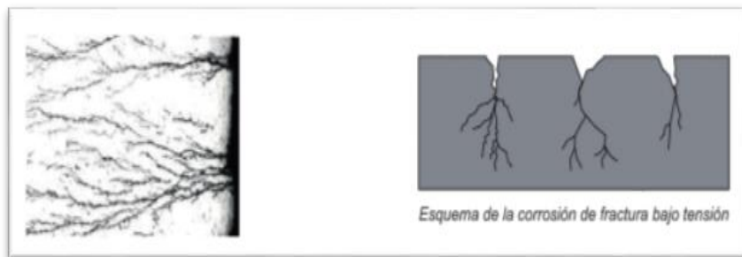
Figura 6.- Corrosión de fractura bajo tensión.
