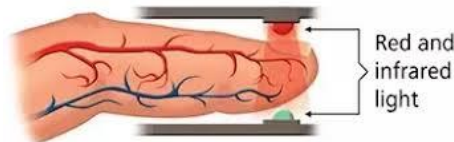
Figura 1. Mecanismo de acción del pulsioxímetro.
