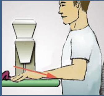
Ejemplo de bordes de superficies de trabajo redondeados, para el apoyo de brazos
